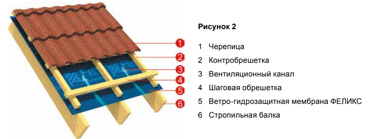
4.2 Утепленная крыша с диффузионной ветро-гидрозащитной мембраной (Рисунок 3).
